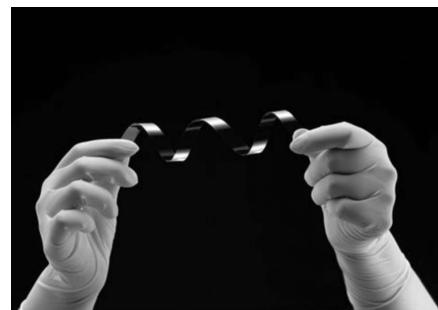
図 9 「スクライブ+ブレイク」で切断した超薄板ガラス(t0.05mm)
