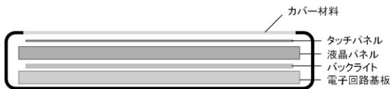
図 8 タッチパネル液晶ディスプレイの構造
