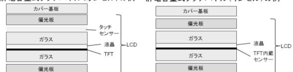
図 11 タッチパネルの構造
